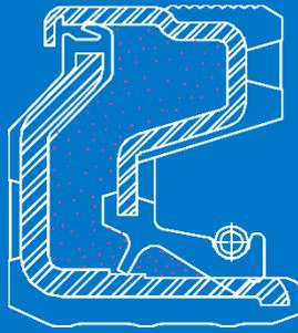
El perfil K7S1 es un retén tipo "cassette" de doble jaula metálica. La parte interior gira de forma independiente a la exterior. Está formado por una pista, un labio de sellado con muelle y varios labios antipolvo integrados en un sistema laberíntico para proteger contra la contaminación externa.
